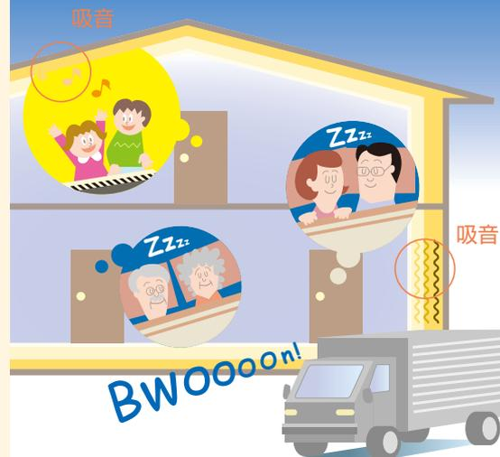
柔軟性に富んだアクアフォームは微細連続気泡構造で、一般的な独立気泡構造と比較し、吸音性に優れています。
